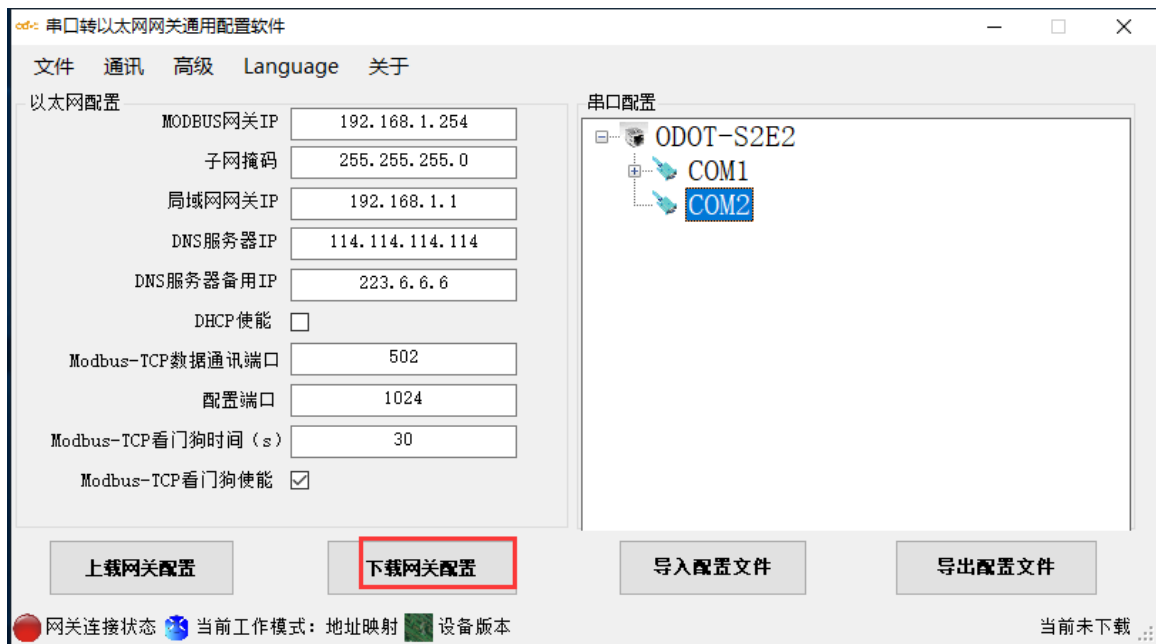
图 3.39 下载网关配置
