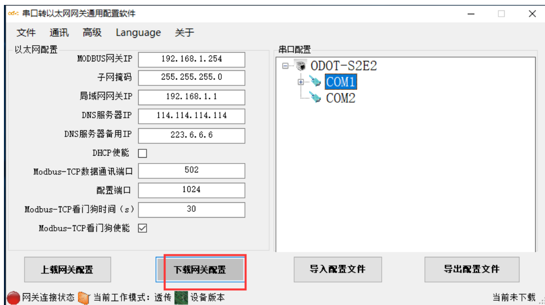
图 3.8 下载网关配置
