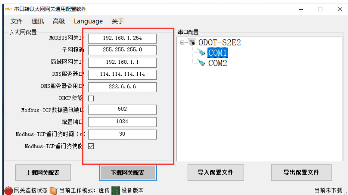
图 3.27 配置网关以太网参数
