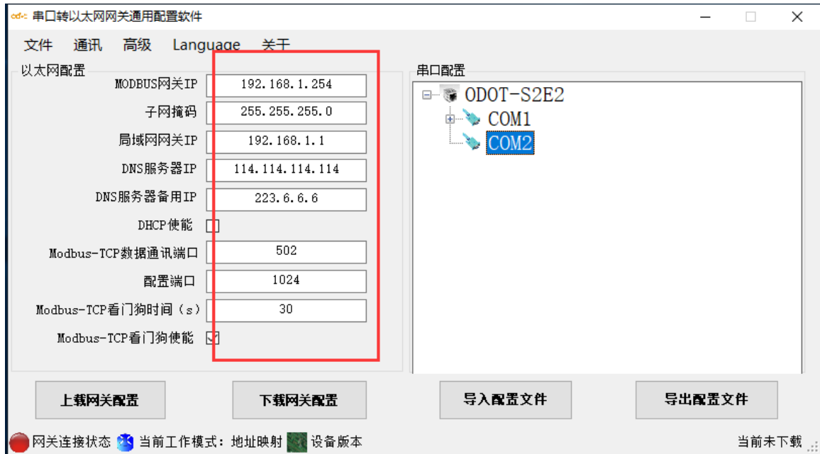
图 3.37 配置网关以太网参数
