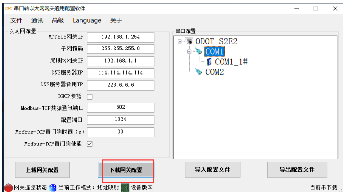
图 3.15 下载网关配置
