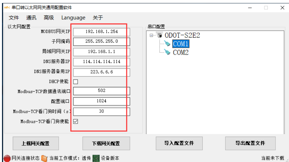
图 3.20 配置网关以太网参数
