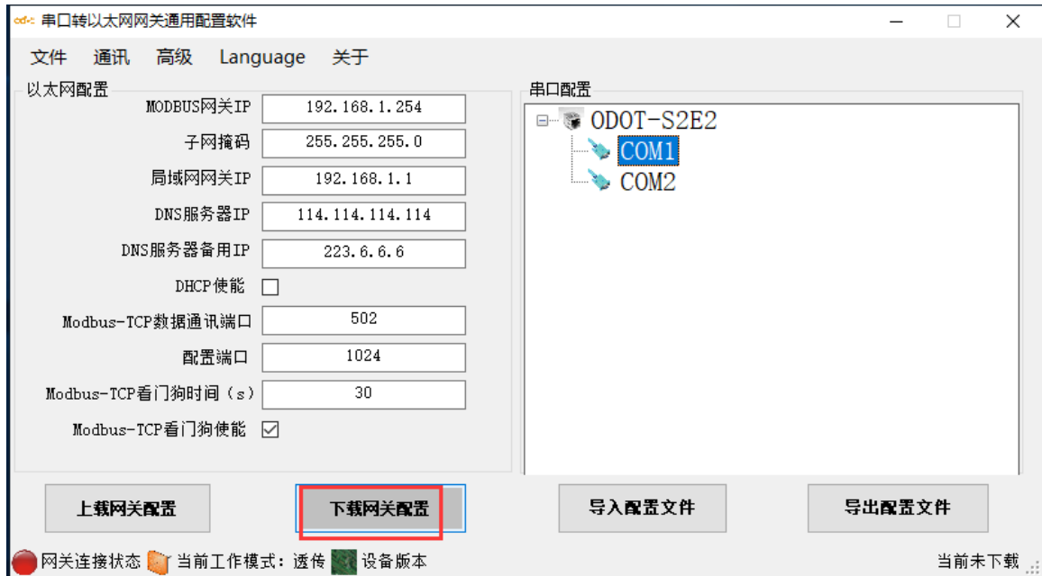
图 3.22 下载网关配置
