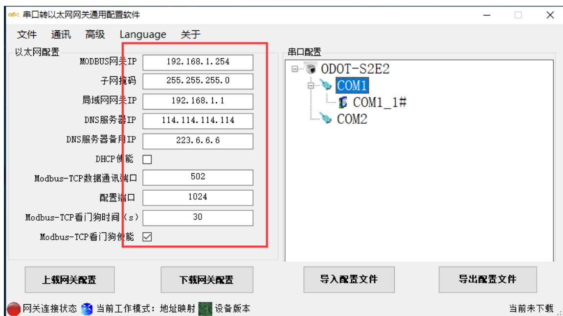
图 3.14 配置网关以太网参数
