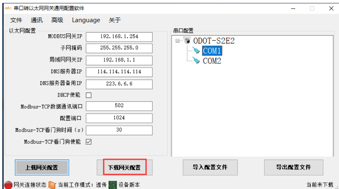
图 3.29 下载网关配置
